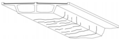
&lt; PSC 박스거더의 균열 &gt;
