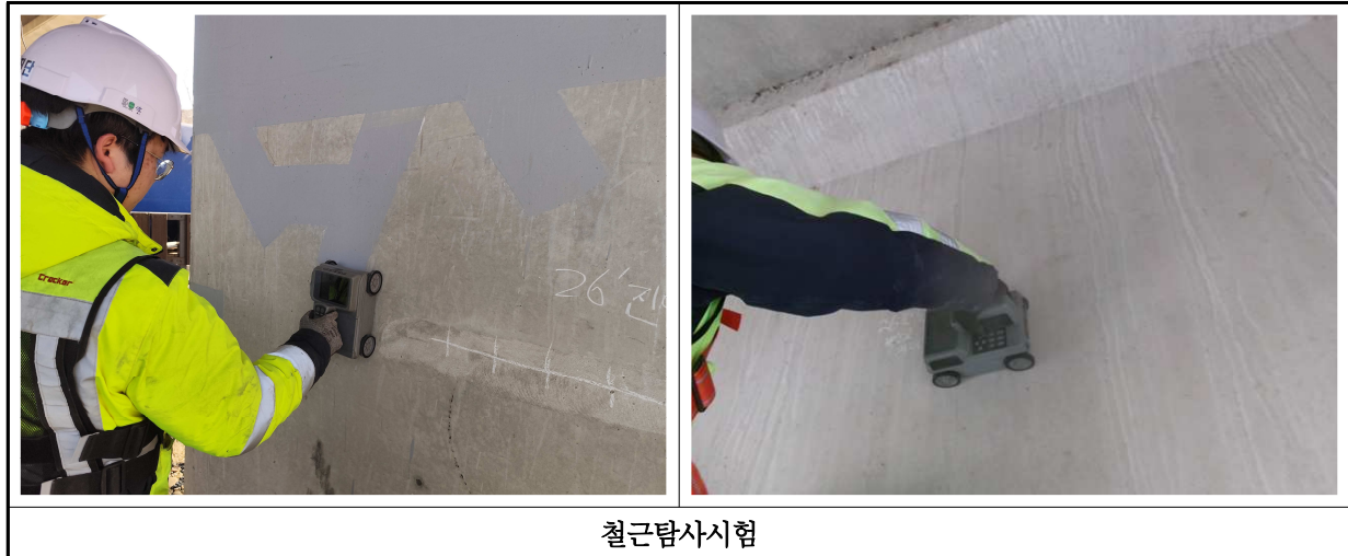
【사진 3.36】 철근탐사시험 현장사진
